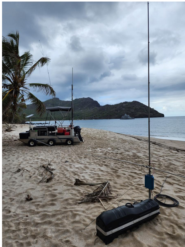
Bild 3: Radio in a box – Aktivität (RIB). Auf der Insel sind die Gerätschaften, aber keine OPs. Letztere arbeiten remote ab Mutterschiff im Hintergrund oder sogar via Starlink von ihrem Zuhause aus. Das Amphibienfahrzeug dient den Transporten und den Maintenance-Besuchen.
